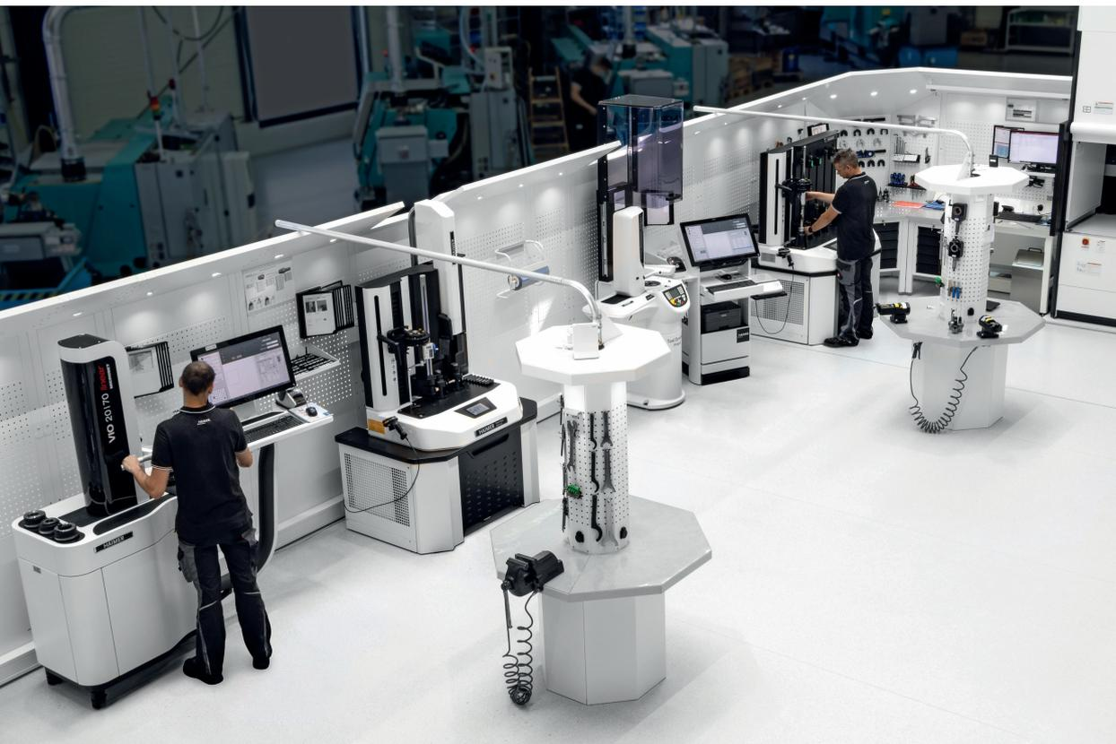
1 Voraussetzung für eine wirksame Automatisierung ist ein gut organisierter Werkzeugraum wie hier bei Haimer in Motzenhofen. Die Tools müssen zentral so vorbereitet und verwaltet werden, dass sie sich bestmöglich in den automatisierten Prozess einfügen © Haimer
