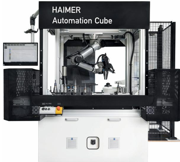
2 Der 'Automation Cube' von Haimer wurde zur Kombinationszelle für das Schrumpfen, Voreinstellen und sogar das Auswuchten erweitert und folgt so dem Anwenderbedarf an personalarmen Lösungen rund um das Werkzeug
